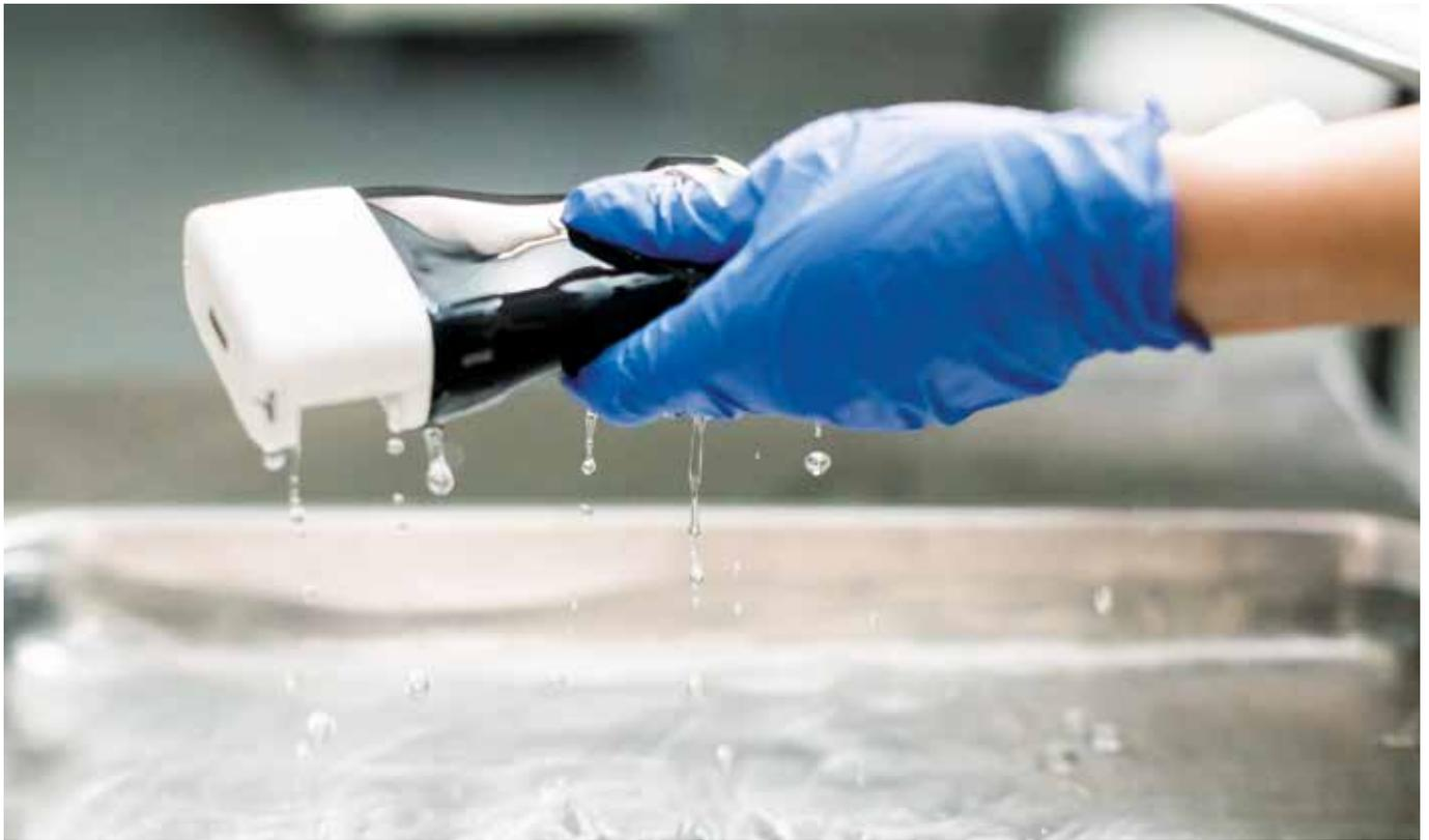
Clarius è progettato e costruito in magnesio con un altissimo grado di robustezza e di impermeabilità ai liquidi rendendolo particolarmente adatto anche in ambienti ad alta criticità e dove la sterilità è particolarmente importante.
